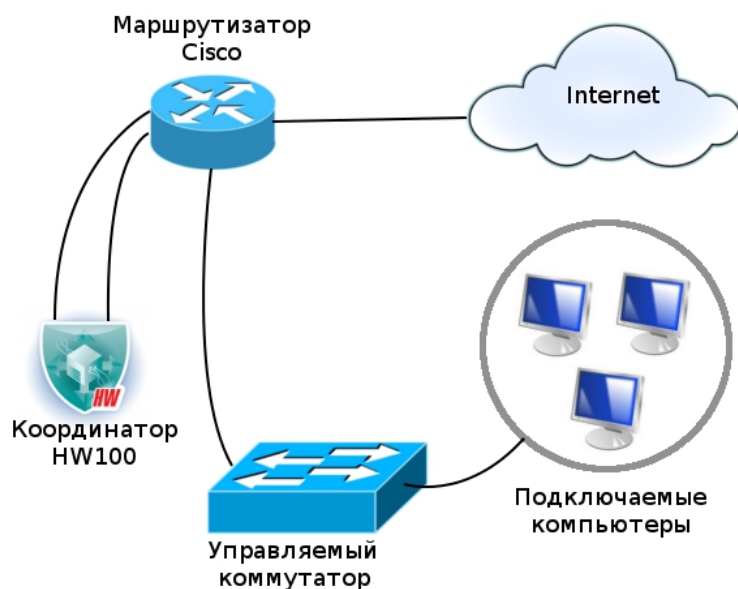
Рис. 4 — Подключение через управляемый коммутатор
